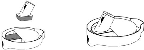
**Deckel** zur Montage des **Ventils** umdrehen, **Ventil** in die passende Aussparung einsetzen. Fest andrücken bis rechts und links die Haltetaschen mit einem Klick-Geräusch einschnappen.
